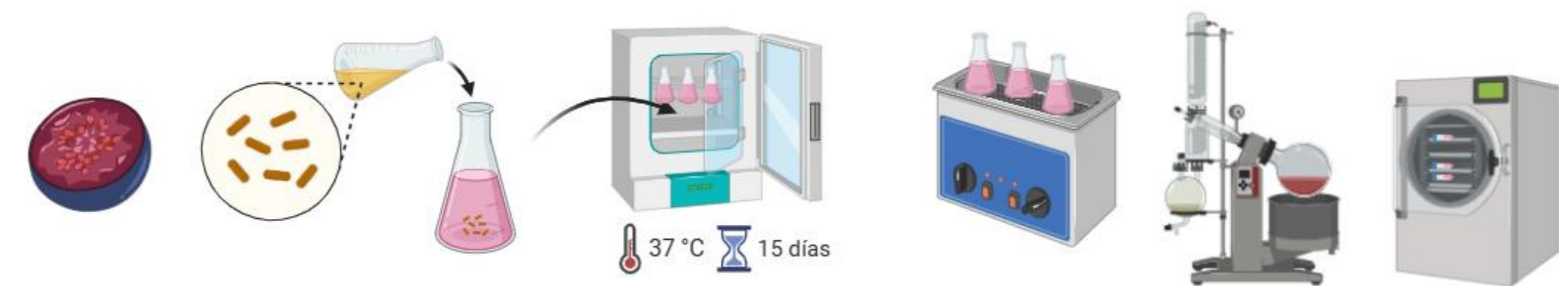
Fig 1. Esquema fermentación orujo de arándano con Lactocaseibacillus casei y extracción de compuestos bioactivos.
